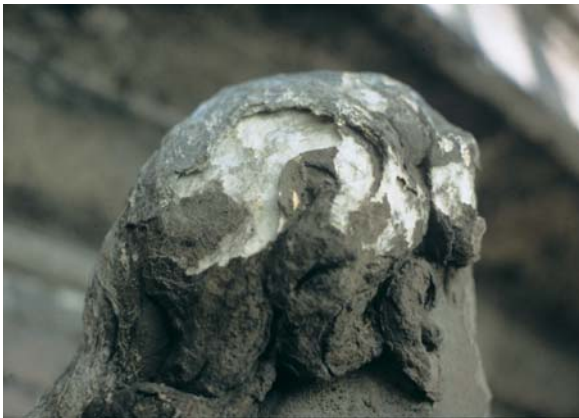
Effetti disgreganti delle croste nere su una scultura di marmo. Crumbling effects caused by black crusts on a marble sculpture.
