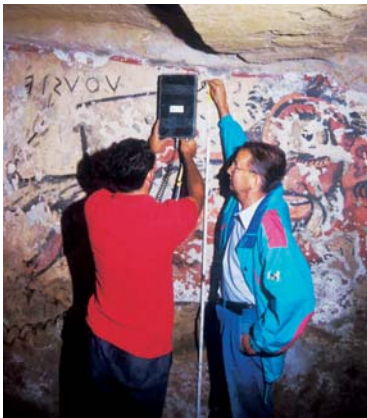
Indagini georadar dall'interno della tomba. Geo-radar surveys conducted from inside the tomb.
