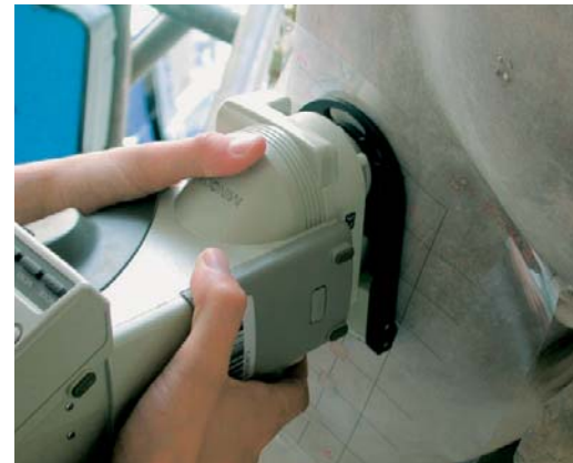
Misure dell'annerimento delle superfici con lo spettrofotocolorimetro. Measurement of surface blackening using spectrophotometer.
