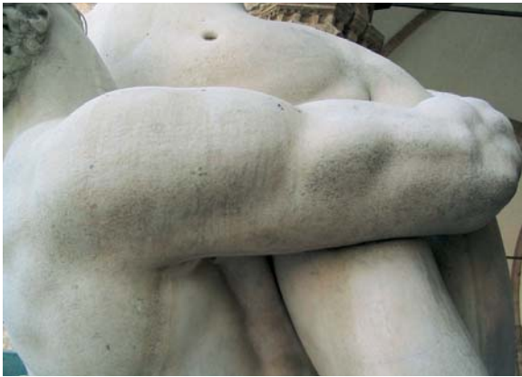
Depositi superficiali neri. Black crusts on surface.
