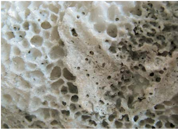
Cavità prodotte da Clionidi nel marmo. Foto ISCR. Cavities caused by Clionids inside marble. Photo ISCR.
