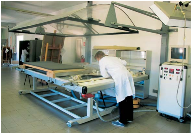
Laboratorio dipinti su tela: intervento conservativo con l'ausilio del tavolo a bassa pressione. Paintings on canvas laboratory: conservative treatment with the aid of a low pressure apparatus.
